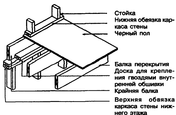
Рисунок 7-4 — Деталь установки доски для крепления внутренней обшивки
